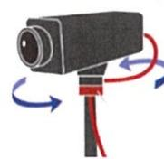
この回転接続コネクターの接点に、水銀が用いられている。水銀は常温常圧でも凝固しない唯一の金属である為、数多く使用されている。
