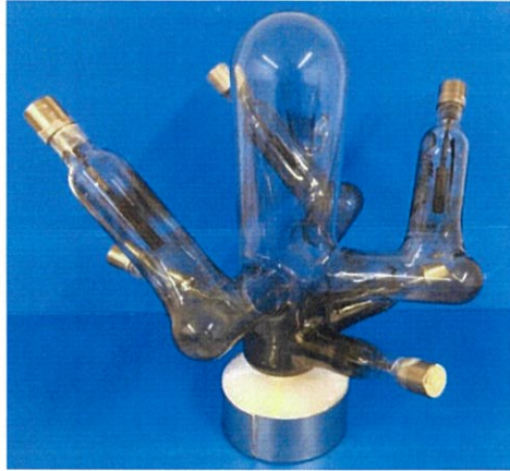
(左) 水銀真空管 (左) 6陽極 水銀整流管 (右) 交流電気機関車
