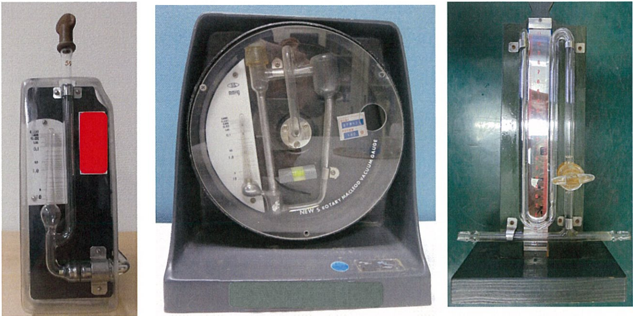
実際に原料として入荷された真空計（左 小型マクラウド真空計 中 マクラウド真空計 右 U字管真空計）
