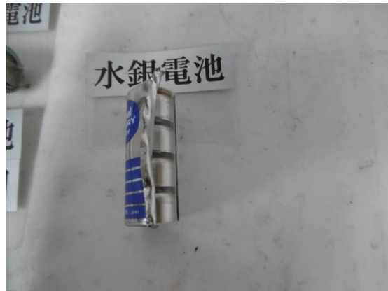
【水銀電池の構造】
